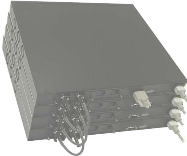
Rysunek 1-3. Łączenie wieży przełączników
